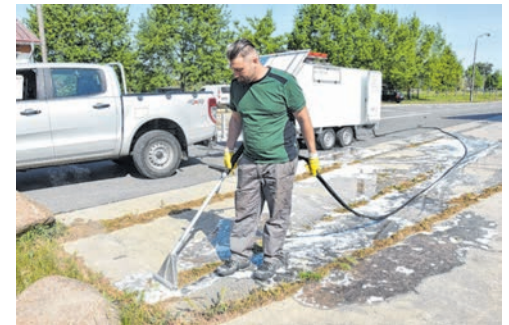
Heißwasser-Schaumgerät zur Ambrosiabekämpfung
