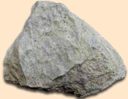
Bild 8: Tertiärquarzit, Grube Babina bei Łęknica, (Breite des Handstückes 18 cm),
